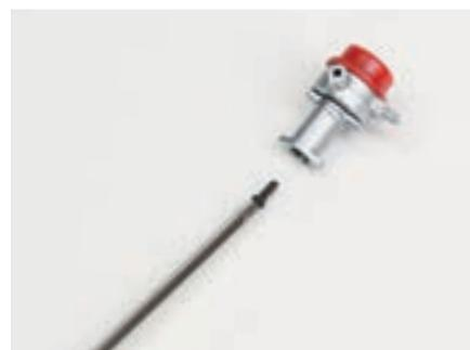
Соберите распределитель зажигания модели. Для этого накройте крышкой корпус распределителя. Обратите внимание на центровочные метки на деталях. Установите собранные детали на основание распределителя и зафиксируйте их винтом 1,7×5 (BP) в отверстиях с нижней стороны.
